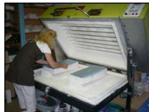
Le verre prend la forme du moule en chauffant dans le four
